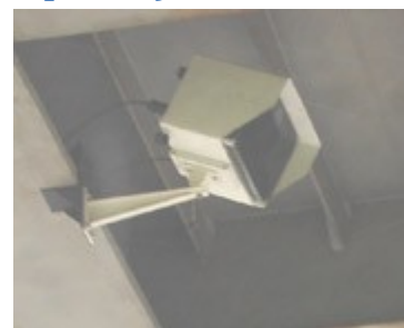
Прибор устанавливается НАД контролируемой полосой движения, например на мосту
